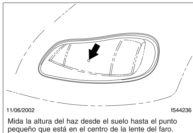
Figura 14.1, Punto de ajuste de la altura del haz del faro
