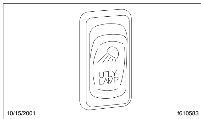
Figura 4.7, Interruptor de las luces de servicio
