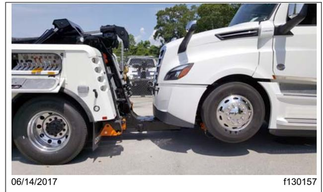
**Figura 24.18, Posición final de remolque**
