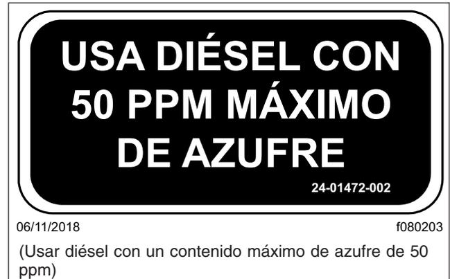
**Figura 11.1, Etiqueta del motor Euro V (se muestra la etiqueta del motor Detroit)**
