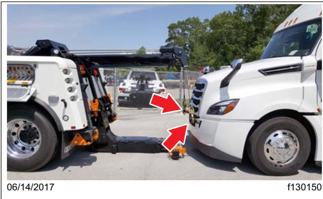
Figura 24.11, Cables de remolque conectados a los ganchos de remolque
