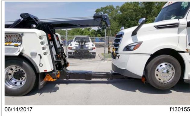
**Figura 24.16, Barra de acoplamiento de remolque con adaptadores de elevación debajo del eje (se muestra el camión remolcador)**
