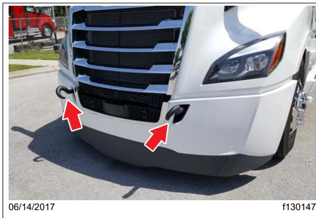
Figura 24.8, Ganchos de remolque instalados, mirando hacia abajo
