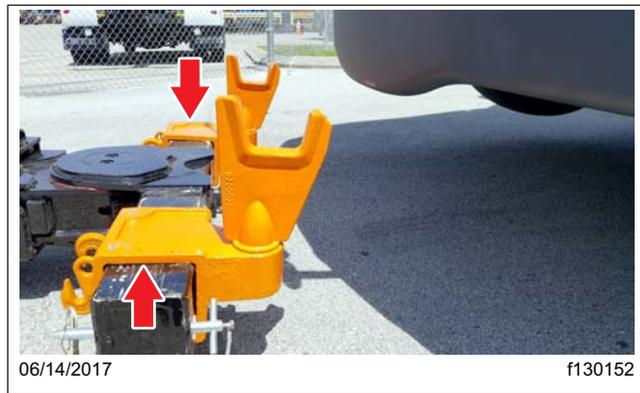
Figura 24.13, Adaptadores de elevación instalados en la barra transversal
