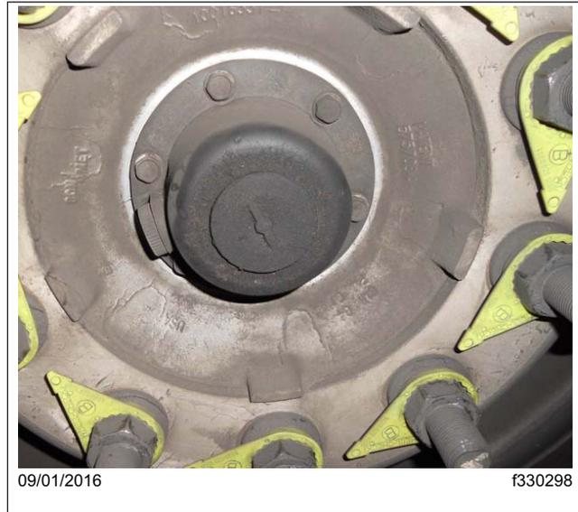
**Figura 13, Ventilación de aceite normal**
