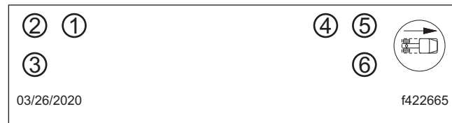
Figura 4, Patrón de apriete de pernos axiales
